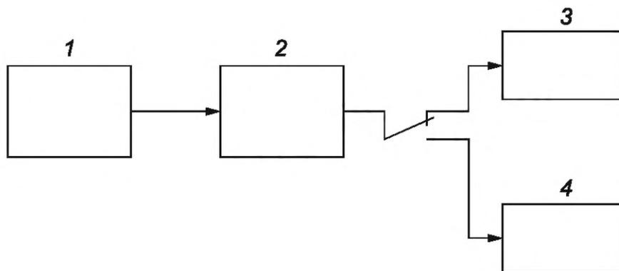
1 — осветитель и оптическая система; 2 — диссектор; 3 — измеритель шума; 4 — измеритель постоянного тока
