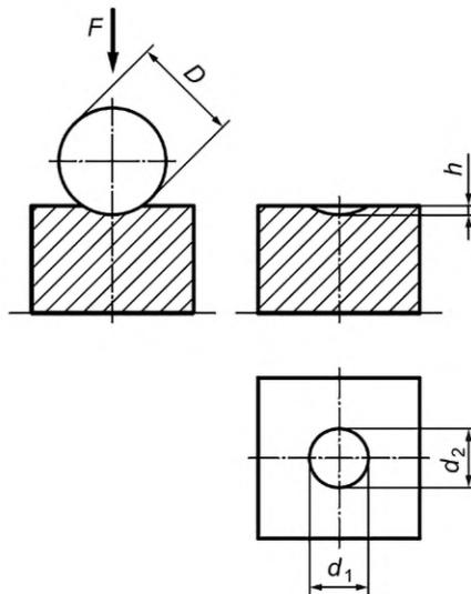
Рисунок 1 — Принцип измерений
