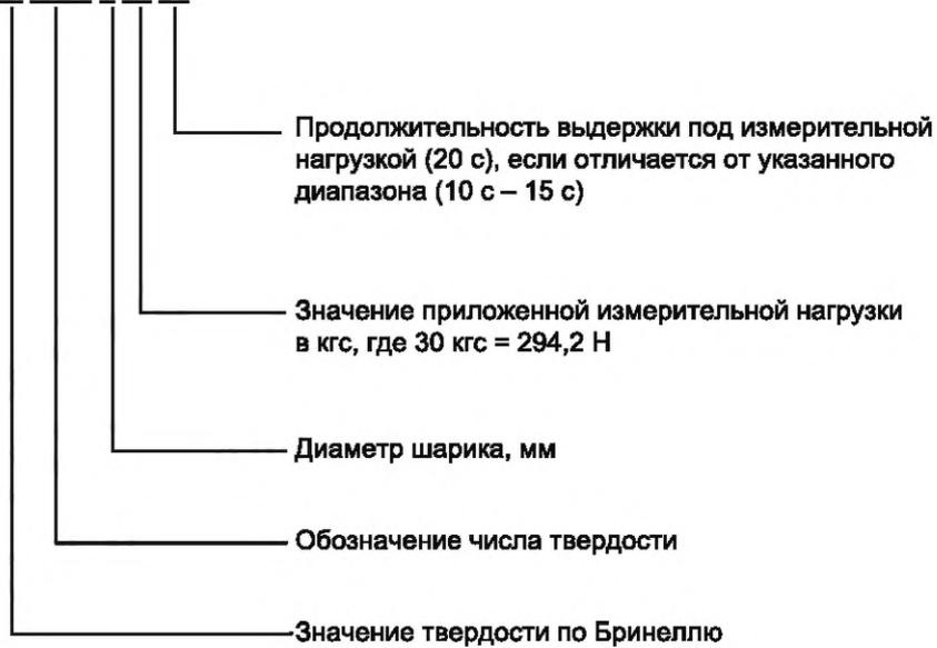
*Примечание* — Символ *W* в обозначении числа твердости указывает на то, что измерения проводились с использованием твердосплавного наконечника. Если измерения твердости проводятся с использованием стального наконечника, то символ *W* в обозначении числа твердости не приводится.
