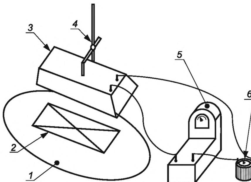
1 — столик для склеивания; 2 — рабочая зона; 3 — лампа (например, ДРТ-220), 4 — штатив; 5 — амперметр;
