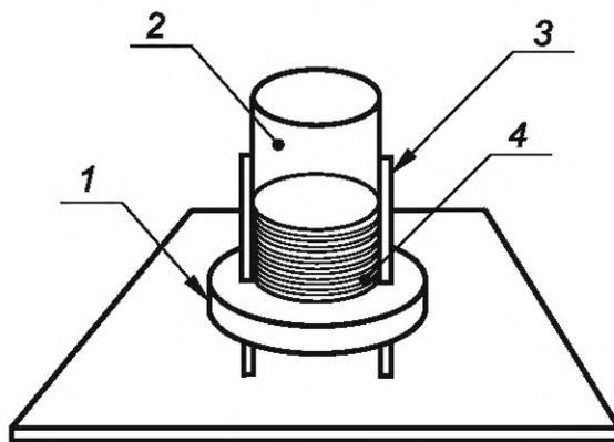
1 — металлическая пластина; 2 — груз; 3 — стержни; 4 — фильтры
