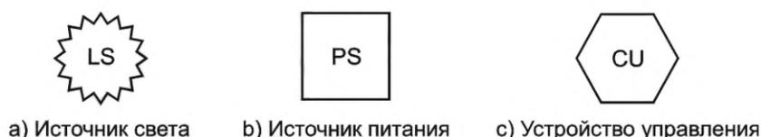
Рисунок 4 — Символы компонентов изделия, предназначенного только для освещения
