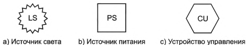
Рисунок 4 — Символы компонентов изделия, предназначенного только для освещения
