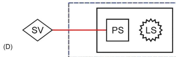
Рисунок В.5 — Измерительная установка для определения входной мощности, подаваемой на комбинированный источник света и источник питания
