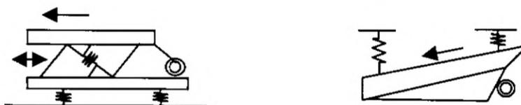
Рисунок 5 — Вибрационный конвейер
