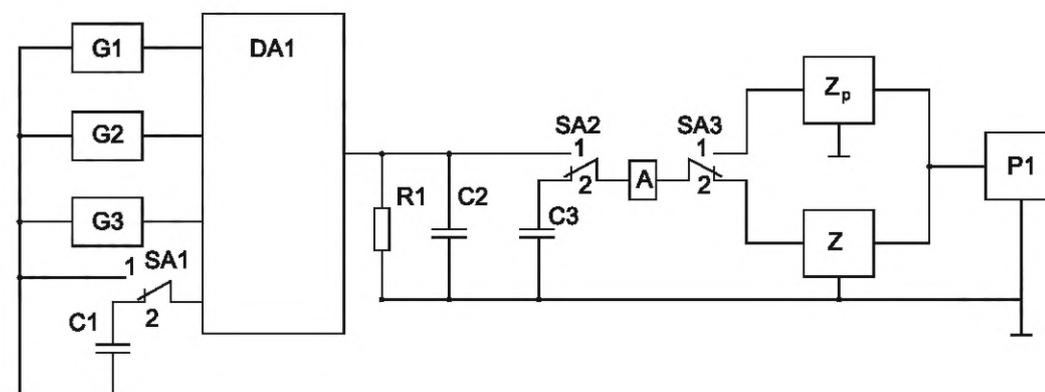
ДА1 — ДАФ; G1, G2 — источники питания; G3 — генератор импульсов тактовых сигналов; Z — фильтр нижних частот; Z<sub>p</sub> — псофометрический фильтр; A — усилитель напряжения; P1 — измеритель переменного напряжения; SA1, SA2, SA3 — устройства коммутации; C1, C3 — конденсаторы разделительные; C2 — конденсатор нагрузки; R1 — сопротивление нагрузки
