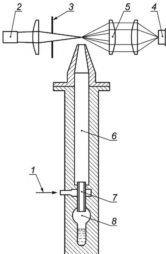
1 — вход аэрозоля; 2 — лазерный диод; 3 — диафрагма; 4 — фотодетектор; 5 — фокусирующая линза; 6 — секция конденсации; 7 — смешивающая форсунка; 8 — ввод паров
