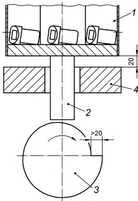
1 — стальной корпус; 2 — поршень; 3 — кулачок; 4 — стальная пластина
