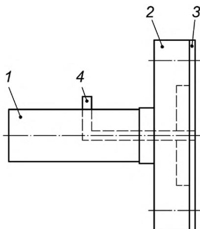
1 — трубка; 2 — корпус адаптера; 3 — крышка адаптера; 4 — пробоотборный порт для вдыхаемого воздуха
