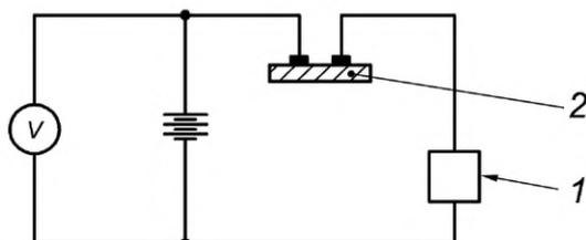
1 — амперметр или гальванометр с шунтом; 2 — образец; V — вольтметр
