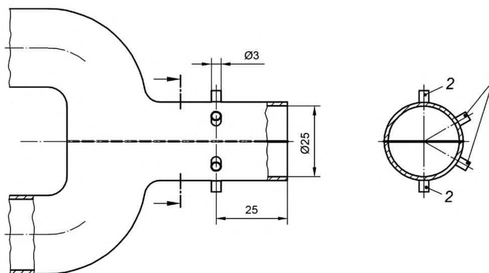
1 — порт измерения давления; 2 — измерительный порт для термопары
