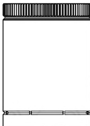
Рисунок 32 — Винтовой колпачок с контролем первого открывания
