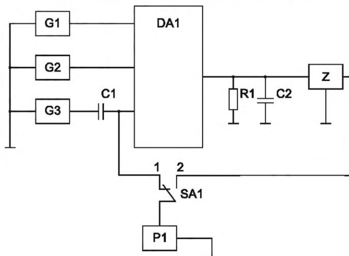
DA1 — ДАФ; G1 — источник питания; G2 — генератор импульсов тактовых сигналов; G3 — генератор входного синусоидального сигнала; P1 — измеритель переменного напряжения; Z — фильтр нижних частот; SA1 — устройство коммутации; R1 — сопротивление нагрузки ДАФ; C1 — конденсатор разделительный; C2 — конденсатор нагрузки ДАФ
