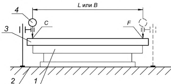
1 — образец-изделие; 2 — поверочная плита; 3 — поверочная линейка; 4 — средство измерений линейных размеров
