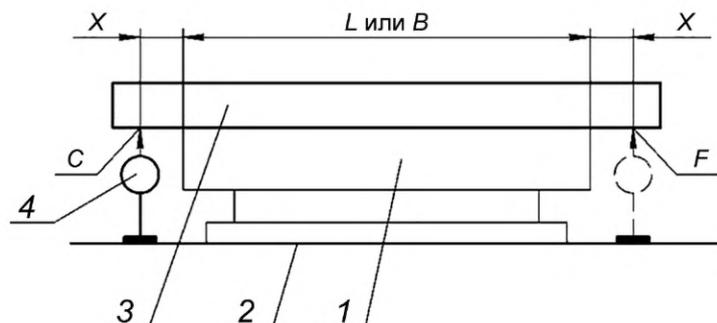
1 — образец-изделие; 2 — поверочная плита; 3 — поверочная линейка; 4 — средство измерений линейных размеров
