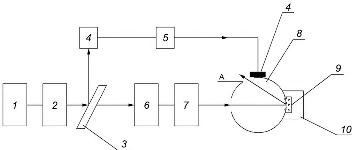
1 — лазер; 2 — регулятор; 3 — делительная пластина; 4 — измерительные преобразователи; 5 — измерительный блок; 6 — оптическая система; 7 — ослабитель; 8 — фотометрический шар; 9 — зеркало; 10 — держатель оптики; А — выходное окно фотометрического шара
