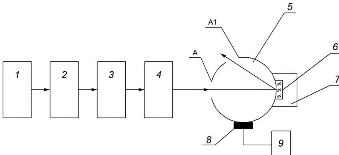
1 — лазер; 2 — модулятор; 3 — оптическая система; 4 — ослабитель (нейтральный светофильтр); 5 — фотометрический шар; 6 — зеркало (мера диффузного отражения); 7 — держатель оптики; 8 — измерительный преобразователь; 9 — регистрирующий прибор; А — входное окно фотометрического шара; А1 — выходное окно фотометрического шара
