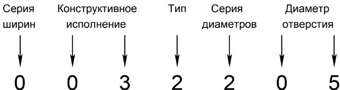
Рисунок 8 — Условное обозначение подшипника 32205
