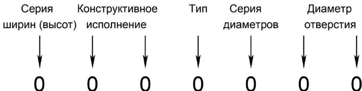
Рисунок 2 — Основное условное обозначение подшипников с номинальным диаметром отверстия 10 мм и более
