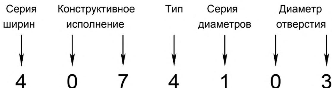
Рисунок 9 — Условное обозначение подшипника 4074103
