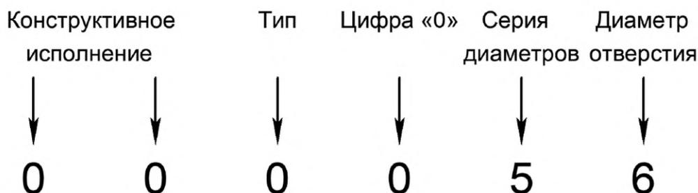
Рисунок 7 — Условное обозначение подшипника 56
