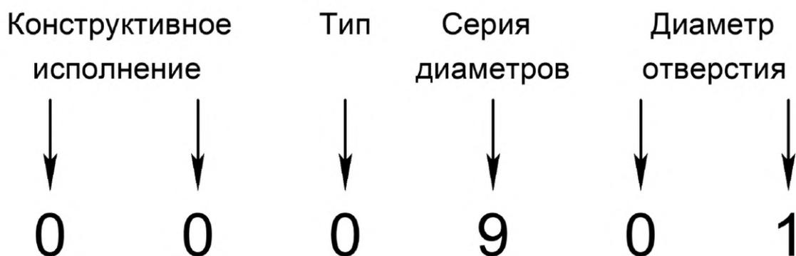
Рисунок 10 — Условное обозначение подшипника 901
