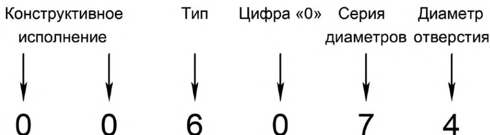
Рисунок 6 — Условное обозначение подшипника 6074
