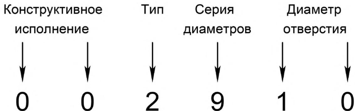
Рисунок 11 — Условное обозначение подшипника 2910
