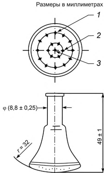
1 — 12 отверстий  $\varnothing (0,86 \pm 0,05)$  на окружности  $\varnothing (21 \pm 0,5)$ ; 2 — 6 отверстий  $\varnothing (0,86 \pm 0,05)$  на окружности  $\varnothing (10 \pm 0,5)$ ;
