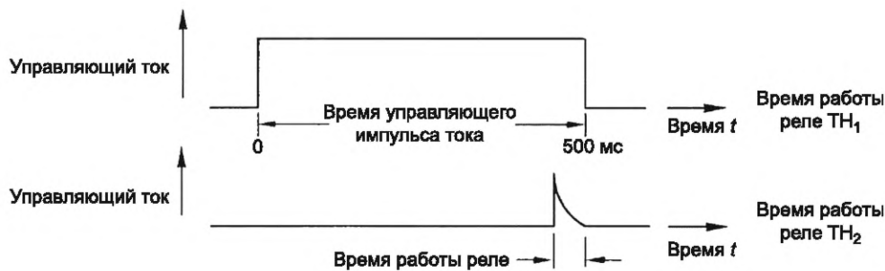
б) временной режим тиристоров T1 и T2
