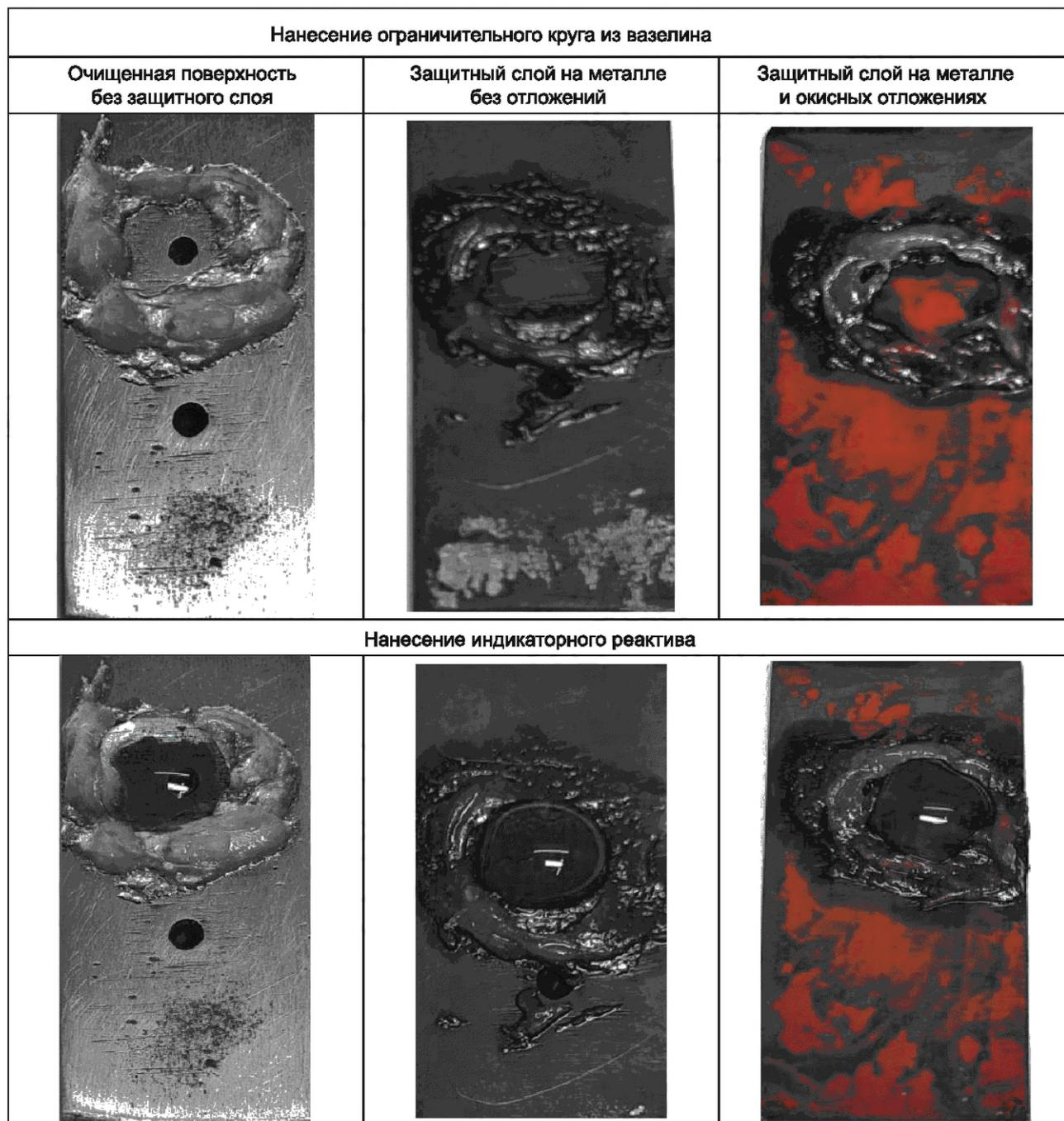
Рисунок В.1 — Тест по проверке защитных свойств барьерных пленок, полученных при применении реагентов ВТИАМИН
