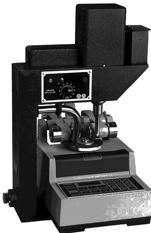
Рисунок 2 — Пример абразиметра Taber® с устройством подачи абразивных частиц 3)
