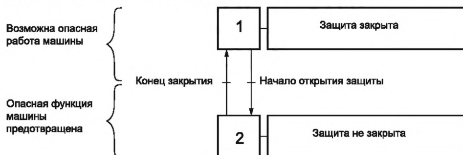
Рисунок 3 — Функциональная схема блокировочных устройств без защитной блокировки
