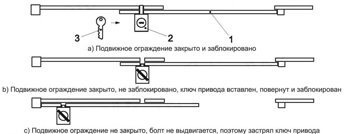
Рисунок В.3 — Принцип блокировки заблокированного ключа — Шаг 1
