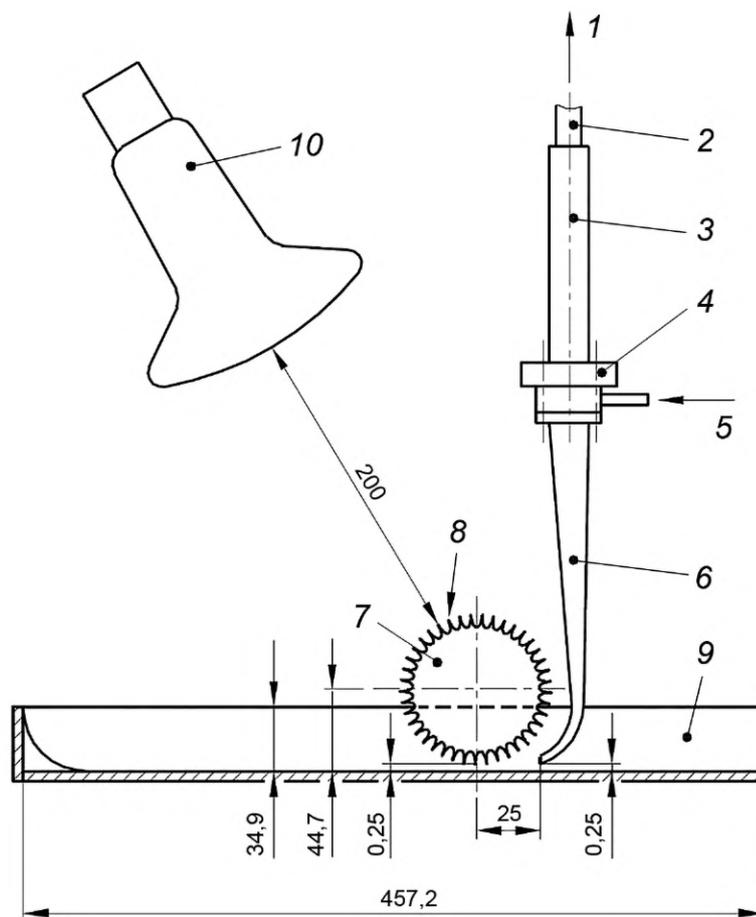
1 — линия подачи пыли (к входному отверстию подачи контрольной пыли); 2 — тонкостенная трубка с гальваническим покрытием; 3 — эжектор Вентури; 4 — эжектор; 5 — отверстие для подачи сжатого воздуха; 6 — трубка для пыли (0,25 мм от лотка с пылью); 7 — зубчатое колесо для отбора пыли (наружный диаметр  $\varnothing 88,9$  мм, длина 114,3 мм, имеет 60 зубьев высотой 5 мм); 8 — зуб колеса; 9 — лоток с пылью; 10 — инфракрасная лампа-рефлектор, 150 Вт
