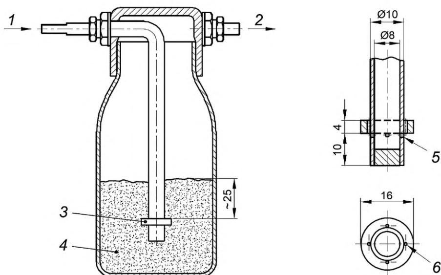
1 — воздух, не содержащий частиц (давление около 17 кПа); 2 — аэрозоль, направляемый в испытательный стенд;
