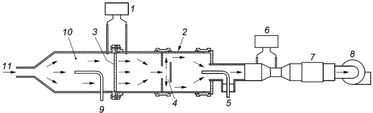
1 — манометр; 2 — испытательный канал; 3 — образец фильтрующего материала; 4 — смесительная секция;
