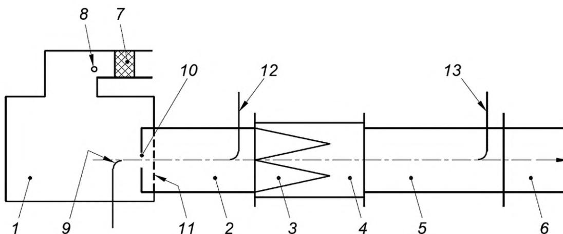
1 — секция воздуховода; 2 — секция воздуховода; 3 — испытуемый фильтр; 4 — секция воздуховода, в которую устанавливается фильтр; 5 — секция воздуховода; 6 — секция воздуховода; 7 — НЕРА-фильтр (не ниже класса H13); 8 — точка ввода частиц DEHS; 9 — форсунка для ввода пыли; 10 — смешивающее отверстие; 11 — перфорированная пластина; 12 — пробоотборник до фильтра; 13 — пробоотборник после фильтра
