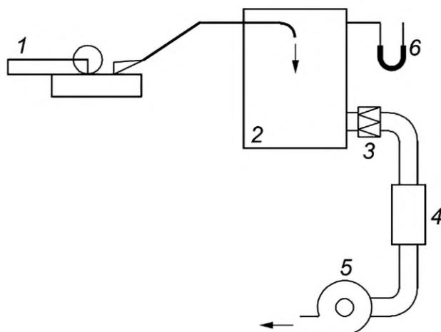
1 — генератор пыли; 2 — емкость объемом не менее 0,25 м<sup>3</sup>; 3 — HEPA-фильтр; 4 — устройство, измеряющее расход воздуха; 5 — вентилятор; 6 — устройство для измерения перепада давления
