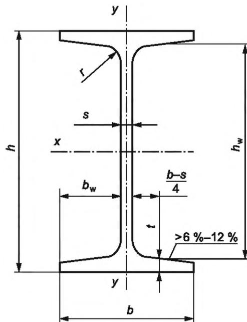
$h$  — высота двутавра;  $b$  — ширина полки;  $s$  — толщина стенки;  $t$  — средняя толщина полки;  $r$  — радиус сопряжения;  $b_w$  — свес полки;  $h_w$  — высота стенки двутавра (в свету между полками)
