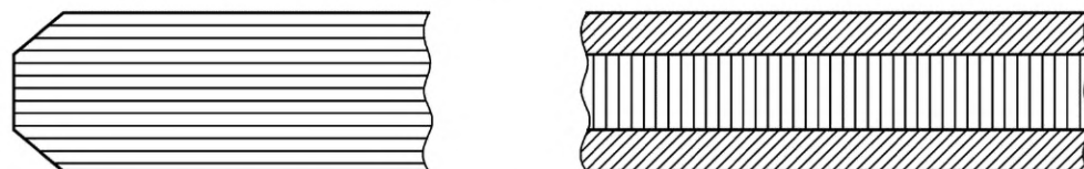
Рисунок 17 — Гладко шлифованная кромка (нет необработанных участков)
