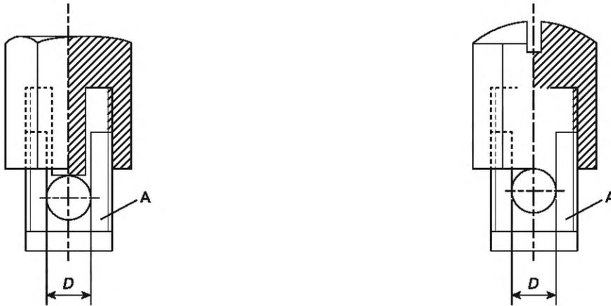
A — неподвижная деталь; D — диаметр проводника
