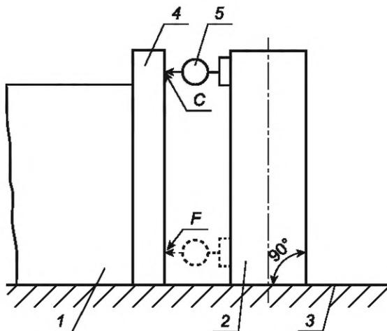
1 — образец-изделие; 2 — цилиндрический угольник; 3 — поверочная плита; 4 — поверочная линейка; 5 — средства измерений линейных размеров
