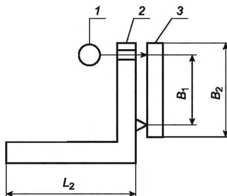
1 — средство измерений линейных размеров (например, индикатор); 2 — угловой держатель; 3 — поворотная поверочная линейка
