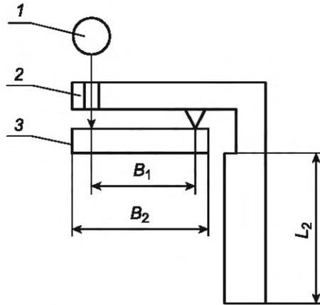
1 — средство измерений линейных размеров (например, индикатор); 2 — угловой держатель; 3 — поворотная поверочная линейка
