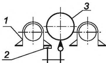
1 — опорная балка; 2 — средство измерений; 3 — шлифовальный цилиндр
