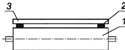
1 — шлифовальный цилиндр; 2 — опора; 3 — поверочная линейка
