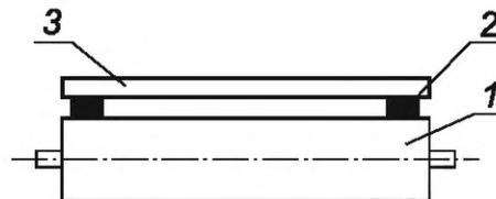
1 — шлифовальный цилиндр; 2 — опоры; 3 — поверочная линейка
