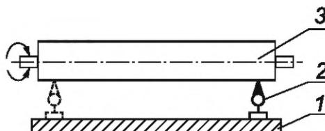
1 — рабочая поверхность конвейера; 2 — средство измерений; 3 — валец
