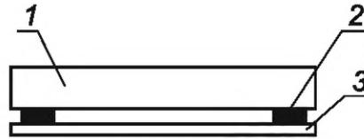
1 — опорная балка; 2 — опоры; 3 — поверочная линейка
