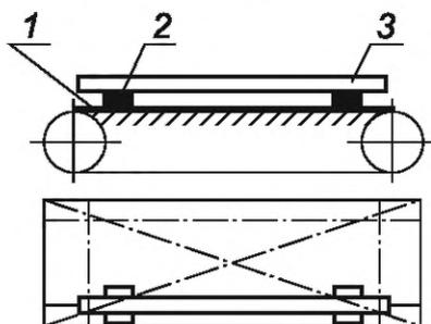
1 — рабочая поверхность конвейера; 2 — опоры;
