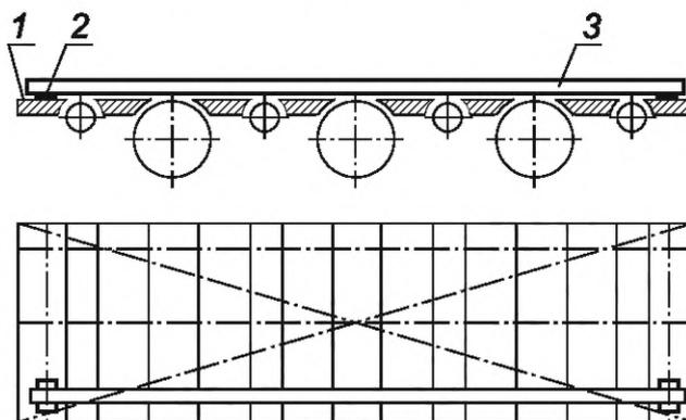
1 — опорная балка; 2 — опора; 3 — поверочная линейка
