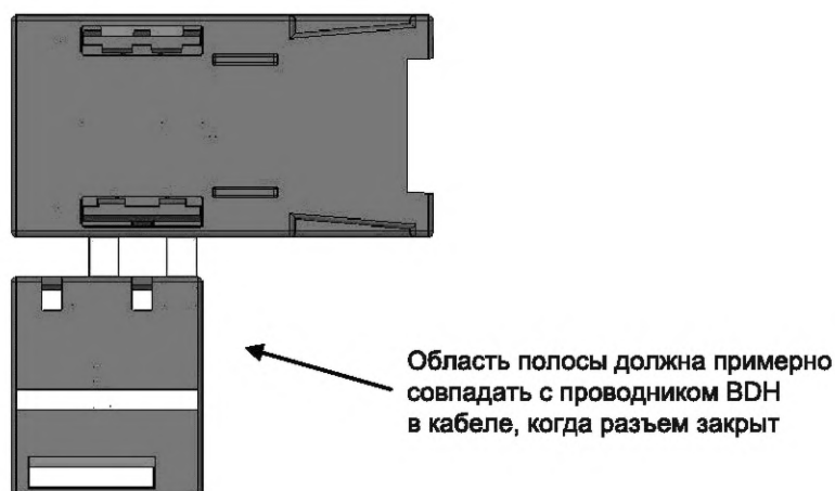
Рисунок 114 — Маркировка разъема для магистральных линий
