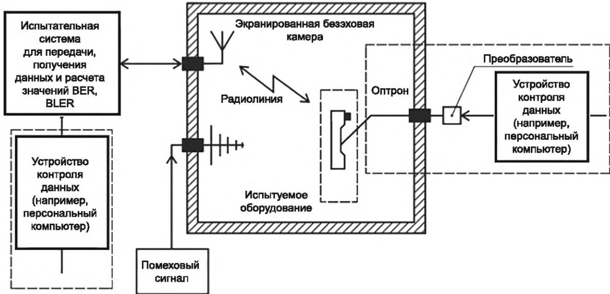
Рисунок С.1 — Схема испытаний при отсутствии вспомогательного оборудования обработки данных
