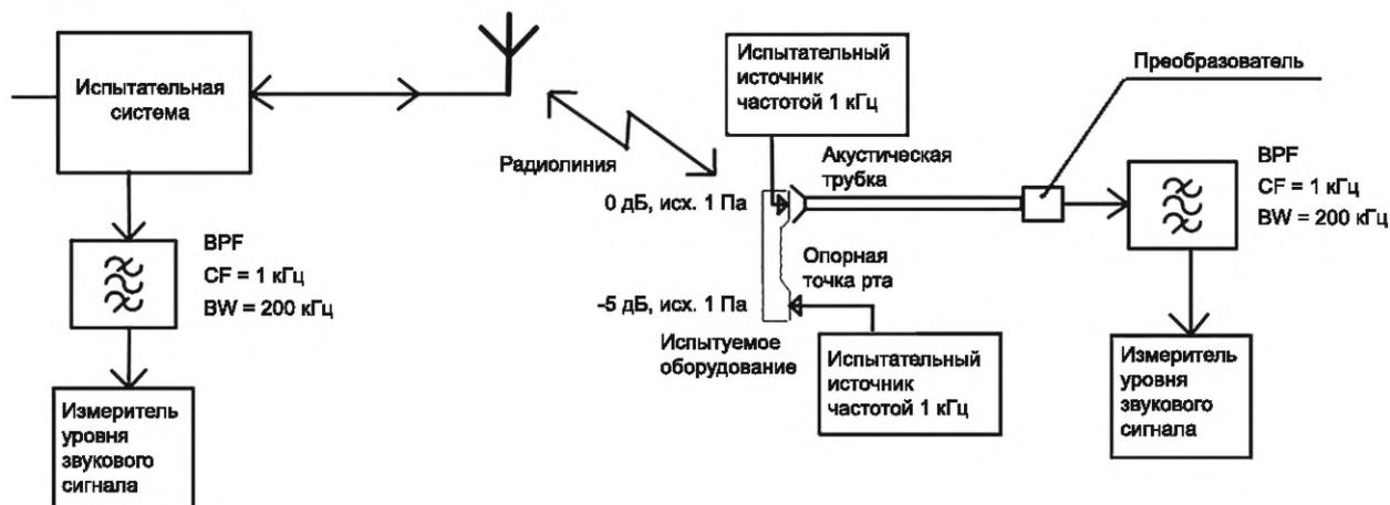
**Примечание** — EUT применяют при установлении опорного уровня выходного звукового сигнала на UL. При установлении опорного уровня выходного звукового сигнала на DL испытуемое оборудование заменяют источником звукового испытательного сигнала с частотой 1 кГц. Во время установления уровня сигнала UL микрофон должен размещаться по отношению к опорной точке рта, как при обычном применении.
