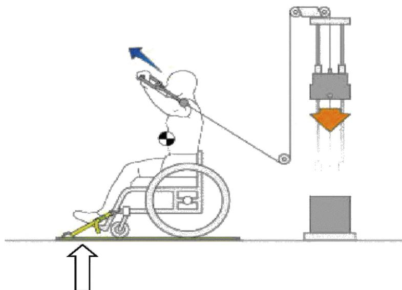
Рисунок А.2 — Пример фиксирующей тяги крепления кресла-коляски
