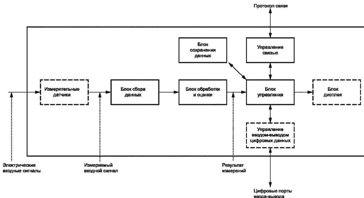
Рисунок 1 — Общее представление измерительных цепей измерительного прибора
