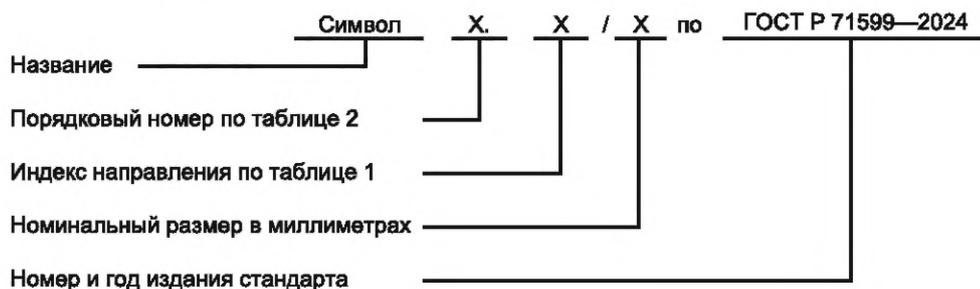
Обозначение комбинированных символов строится по следующей схеме:
