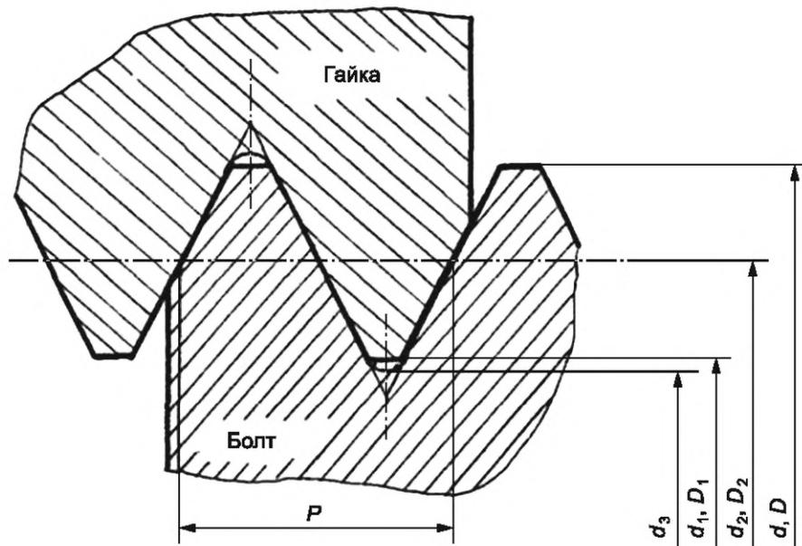
Рисунок 1 — Профиль метрической резьбы с обозначением его элементов
