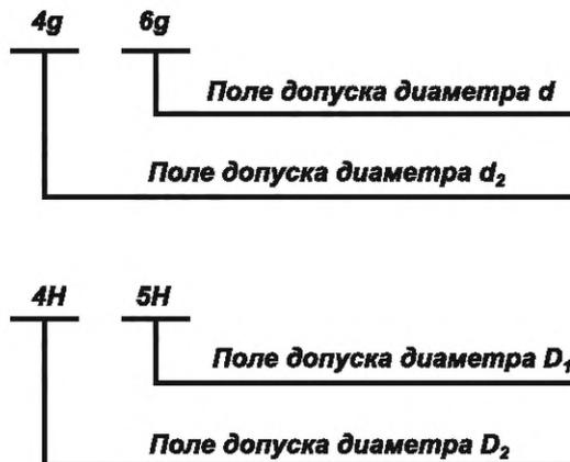
Если обозначение поля допуска диаметра по вершинам резьбы совпадает с обозначением поля допуска среднего диаметра, то в обозначении поля допуска оно не повторяется.
