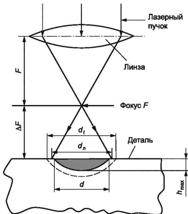
$F$  — фокусное расстояние линзы, мм;  $\Delta F$  — дефокусировка лазерного пучка, мм;  $d_t$  — ширина зоны лазерного воздействия на обработанной поверхности, мм;  $d_n$  — диаметр сфокусированного пятна, мм;  $d$  — ширина зоны упрочнения на обработанной поверхности, мм;  $h_{\max}$  — наибольшая толщина зоны воздействия, мм
