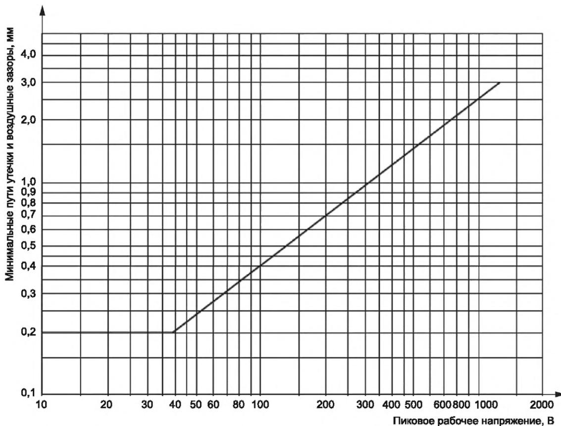
Кривая определяется по формуле:  $\log d = 0,78 \log (U/300)$  с минимальным отклонением 0,2 мм, где  $d$  — расстояние;  $U$  — пиковое напряжение (В).
