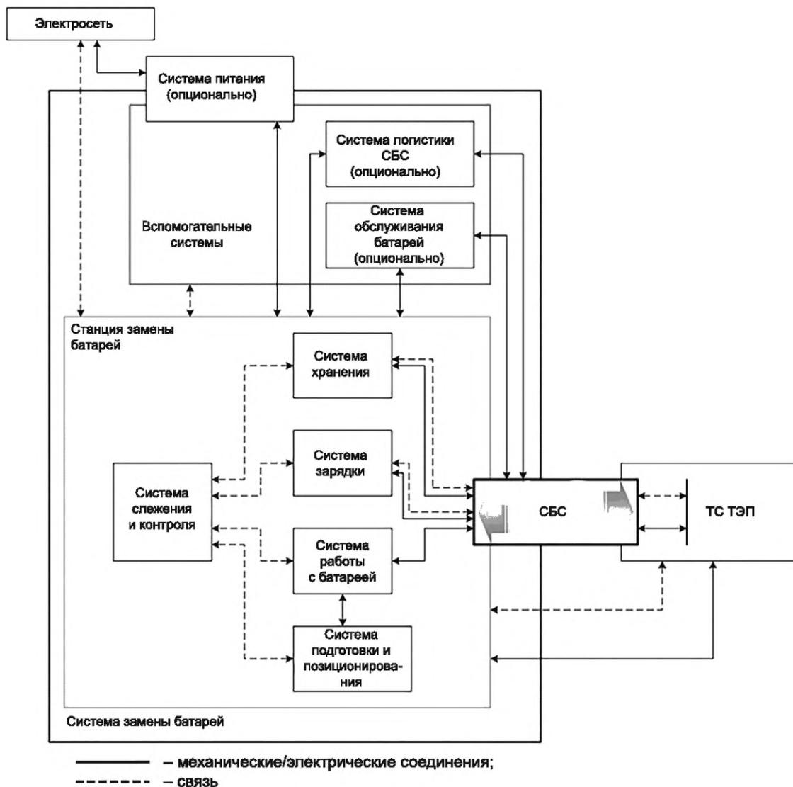
Рисунок 1 — Система замены батарей ТС ТЭП
