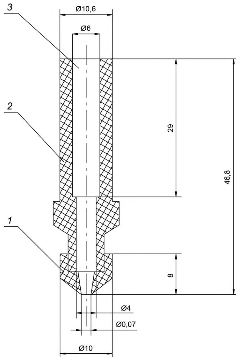
1 — наконечник (из резины); 2 — корпус ячейки (из органического стекла); 3 — отверстие для вспомогательного электрода (Pt, нержавеющая сталь)
