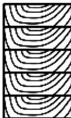
Рисунок 1 — Ориентация слоев в деревянном клееном элементе
