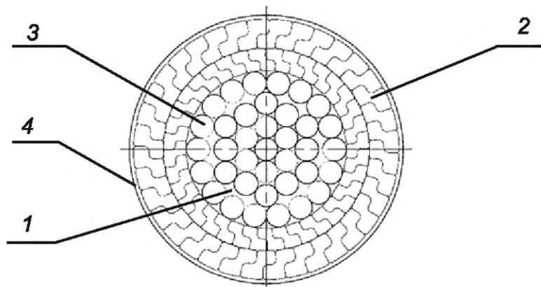
1 — защитная смазка; 2 — зетобразная проволока; 3 — круглая проволока;
