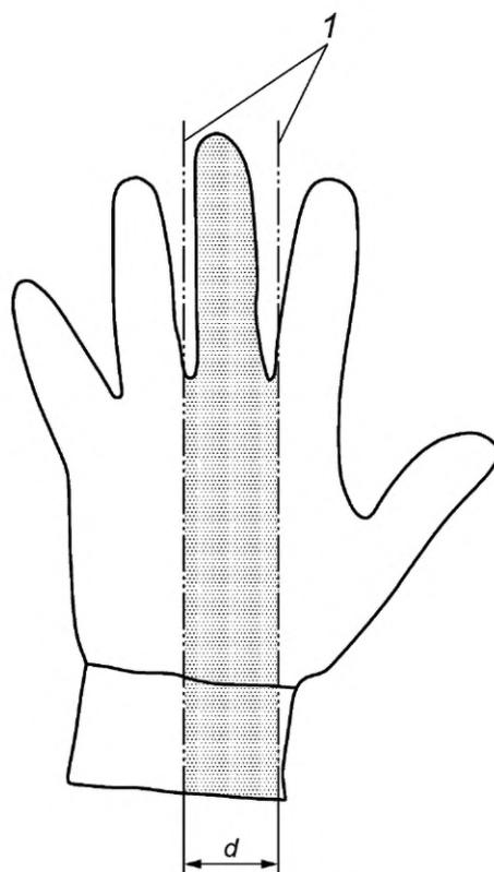
1 — линия разреза;  $d = (30 \pm 5)$  мм
