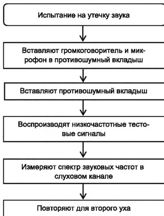
Рисунок 6 — Блок-схема для испытания на утечку звука
