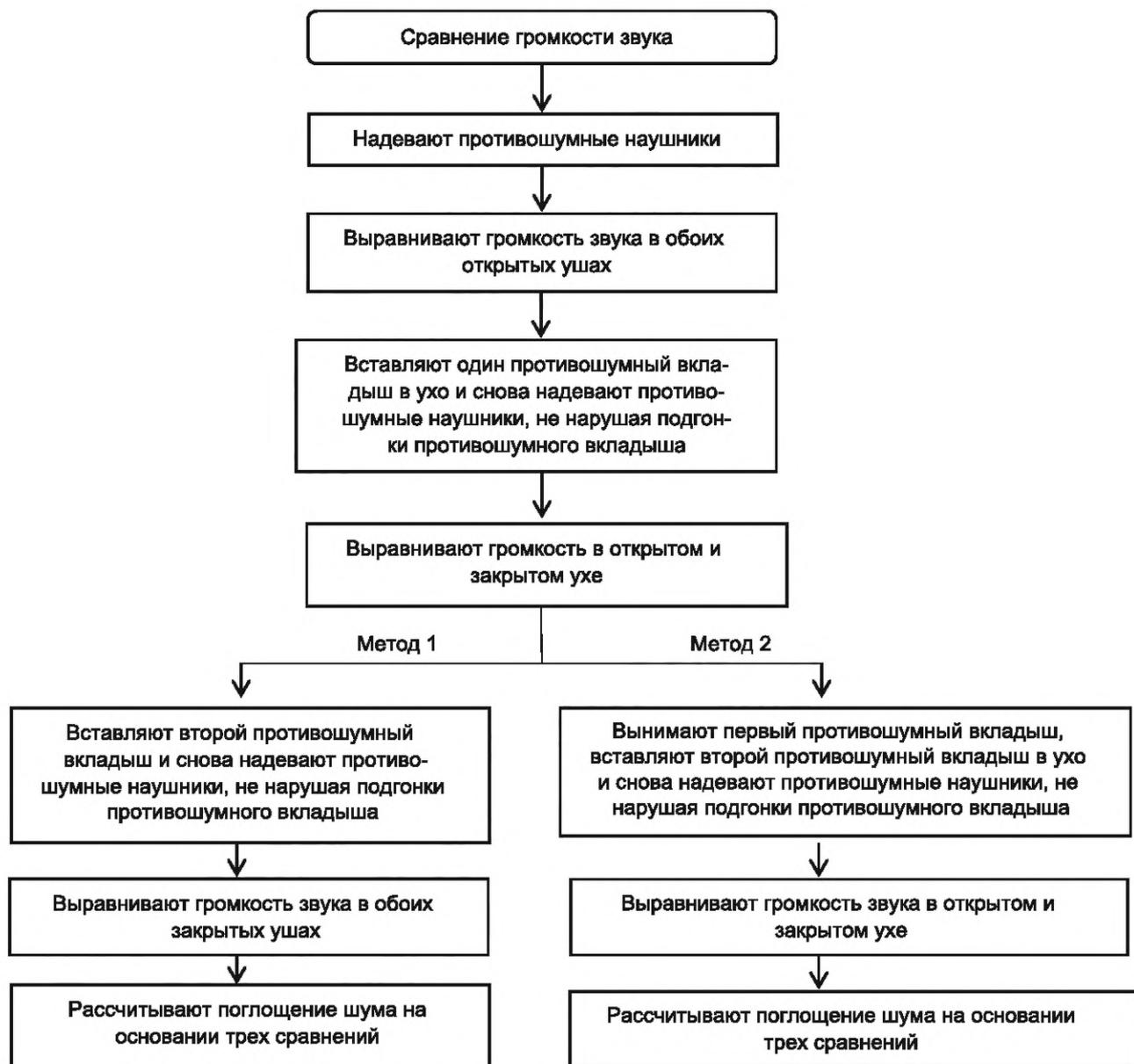
Рисунок 5 — Блок-схема для метода сравнения громкости
