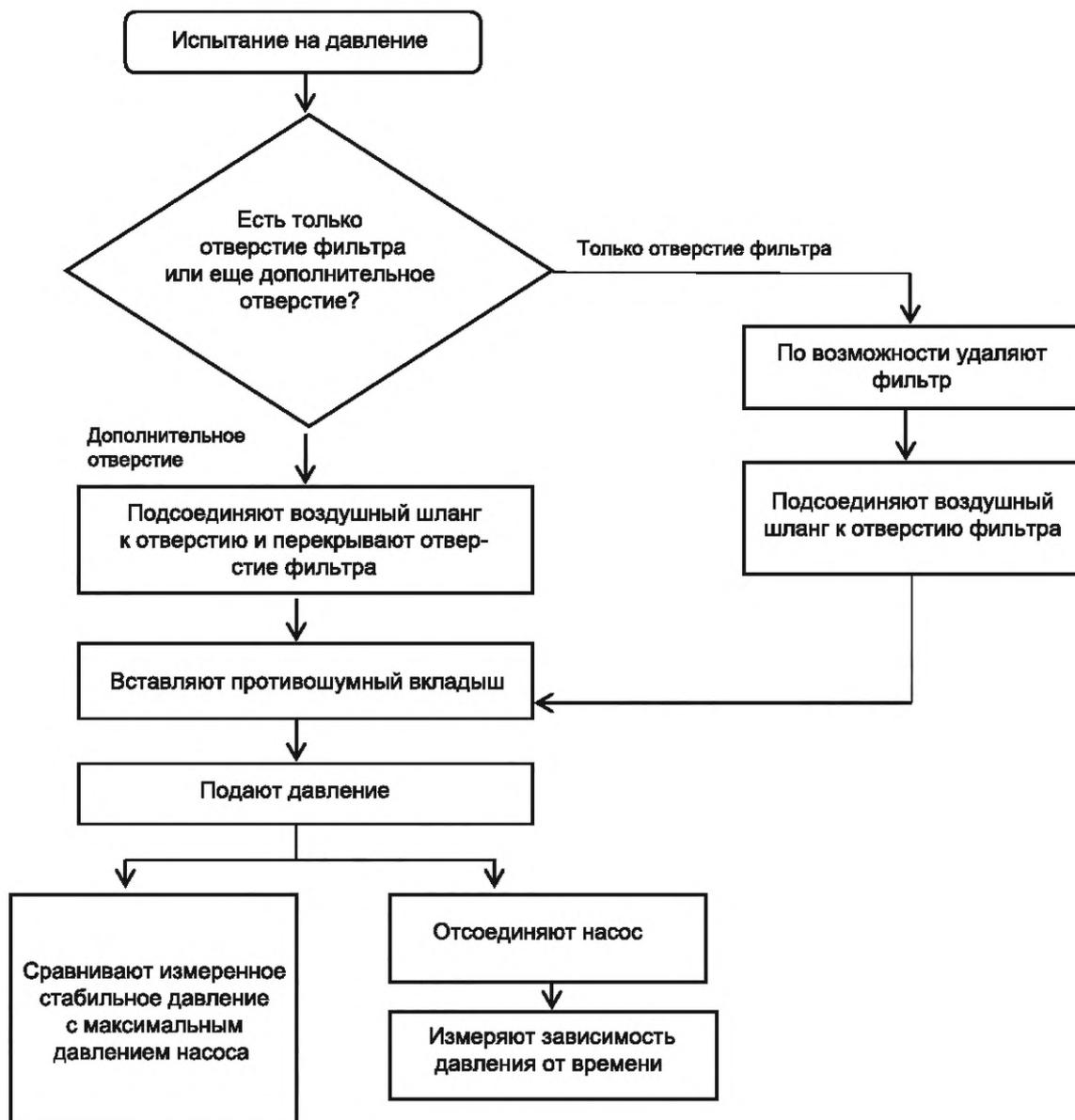
Рисунок 7 — Блок-схема для испытания на давление
