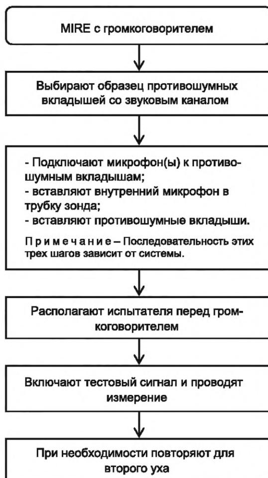
Примечание — При проведении измерений противошумных наушников эта блок-схема является примером использования замещающих образцов противошумных наушников.
