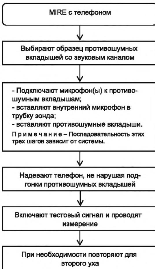
Рисунок 1 — Блок-схема для метода 1а
