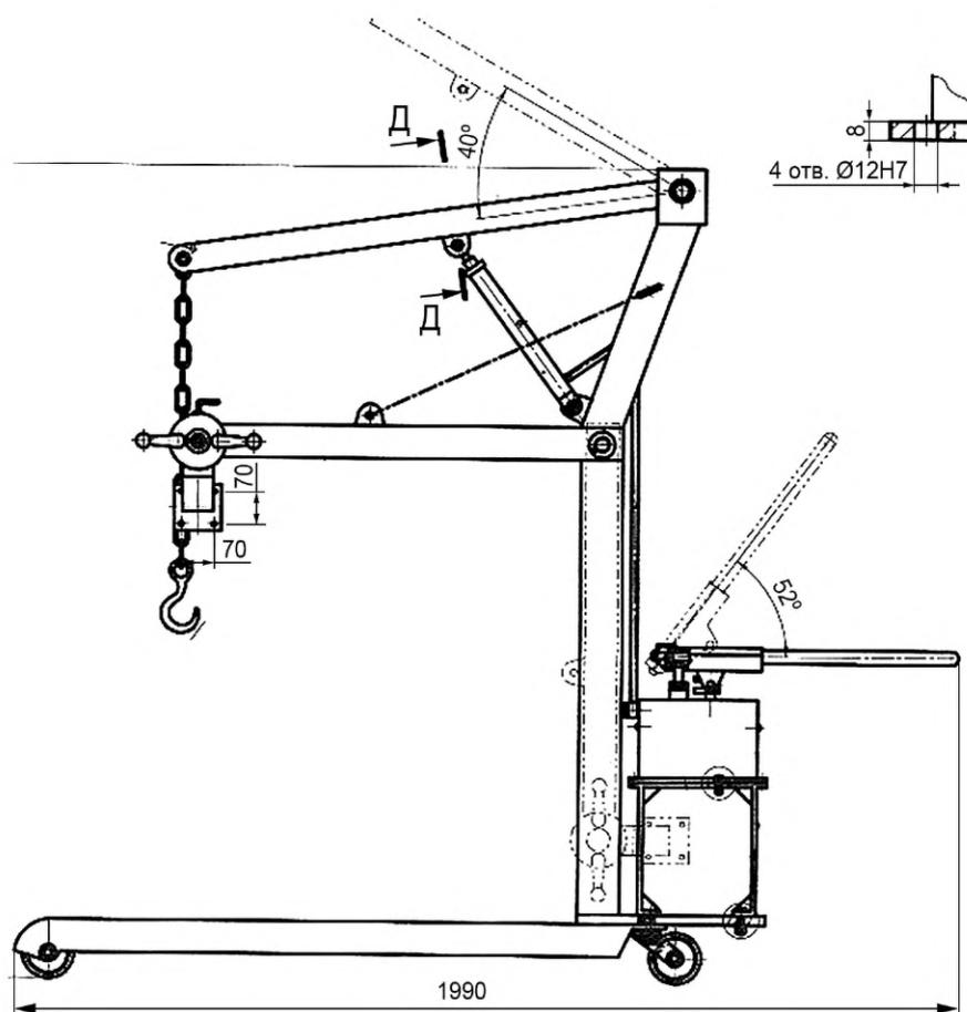
Рисунок Д.5 — Тележка для снятия и транспортировки агрегатов
