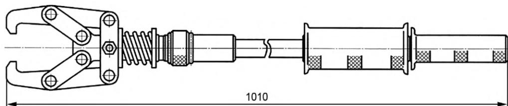
Рисунок Д.6 — Инерционный съемник (СКНТЦ ГОСНИТИ 000000. 003)
