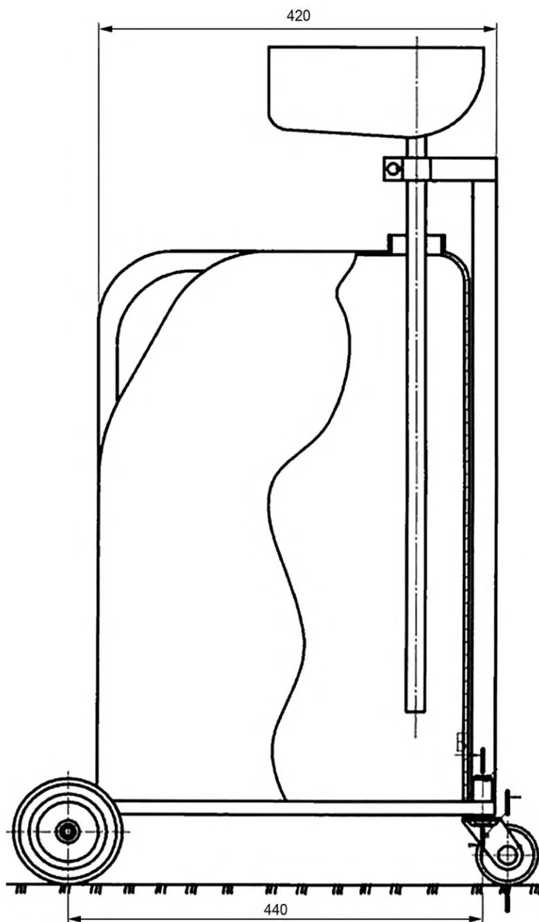
Рисунок Д.4 — Тележка под канистру для слива и перевозки горюче-смазочных материалов
