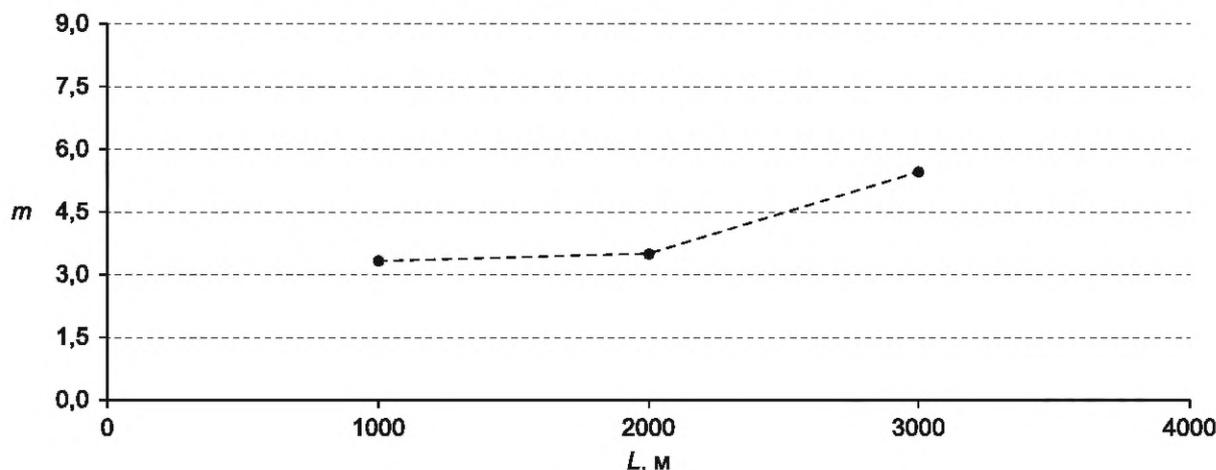
Рисунок Г.1 — Значения коэффициента  $m$  при разных глубинах скважины (I и II конструкционные группы скважин)
