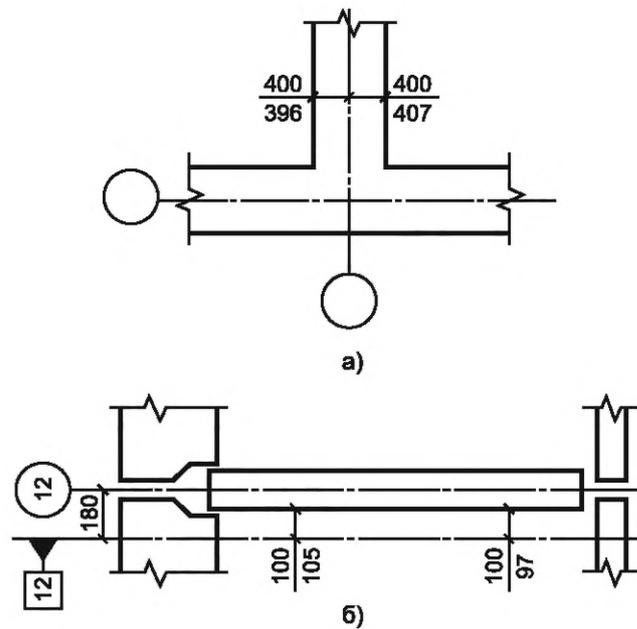
а) от граней монолитного ростверка до вынесенной оси;
