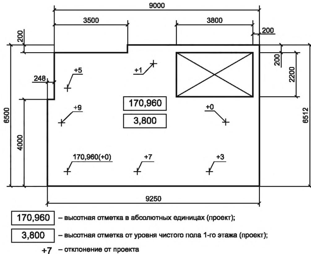
Рисунок Б.2 — Примеры указания действительных отклонений поверхностей
