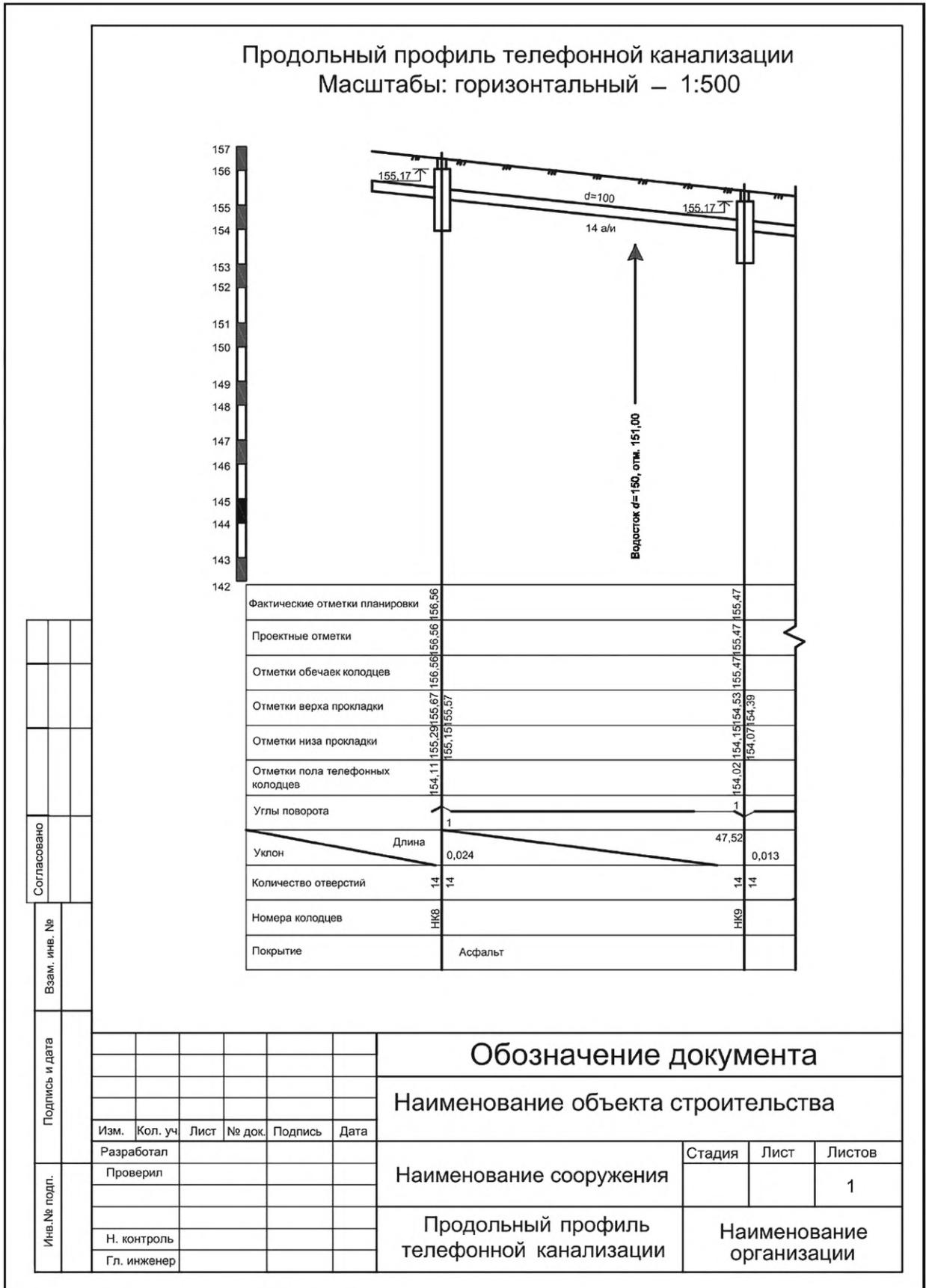
Рисунок Д.3 — Исполнительный чертеж телефонной канализации. Профиль
