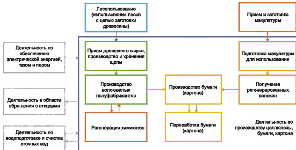
Рисунок 1 — Блок-схема целлюлозно-бумажного производства
