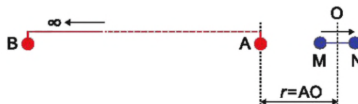
Рисунок 7 — Схема установки точечных электрических зондирований
