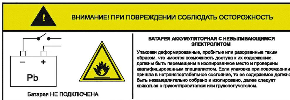
Рисунок DD.1 — Предупреждающая этикетка для продукции, транспортируемой с неподключенными батареями
