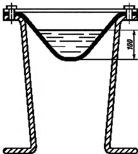
Рисунок 4 — Приспособление для определения водопроницаемости методом кошеля
