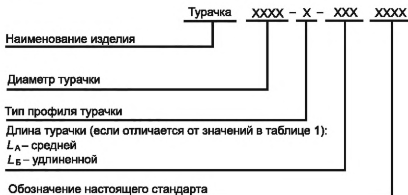
Рисунок 3 — Схема условного обозначения турачки
