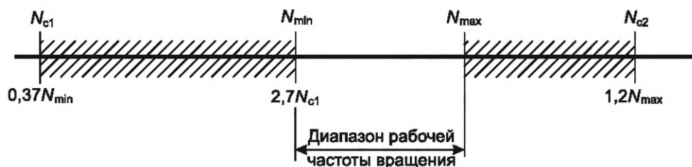
Рисунок 1 — Предельные значения критических частот вращения относительно диапазона рабочих скоростей для случая вала, не являющегося «жестким»
