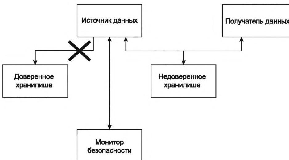
Рисунок А.12.3 — Шаблон «Динамическое ограничение доступа к данным», система в рабочем состоянии
