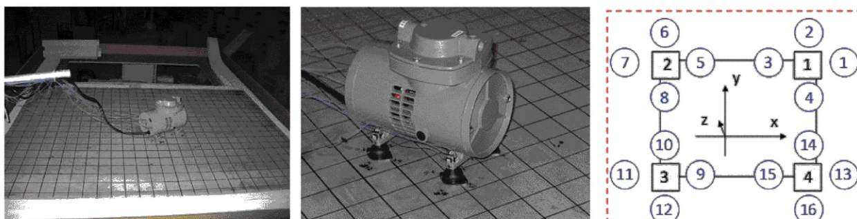
Рисунок С.4 — Иллюстративный материал к примеру 3 (квадратами с цифрами изображены упругие опоры, кружочками с цифрами — акселерометры в точках контроля)
