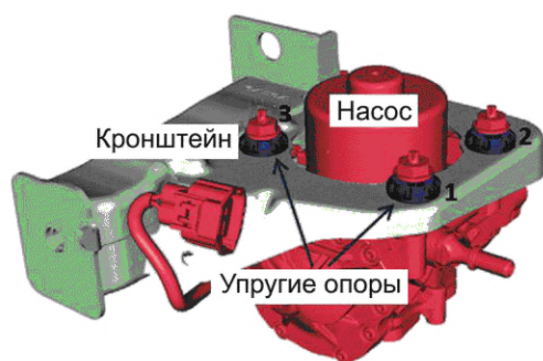
а) Насос/источник, соединенный с кронштейном/приемником через три упругие опоры/точки контакта
