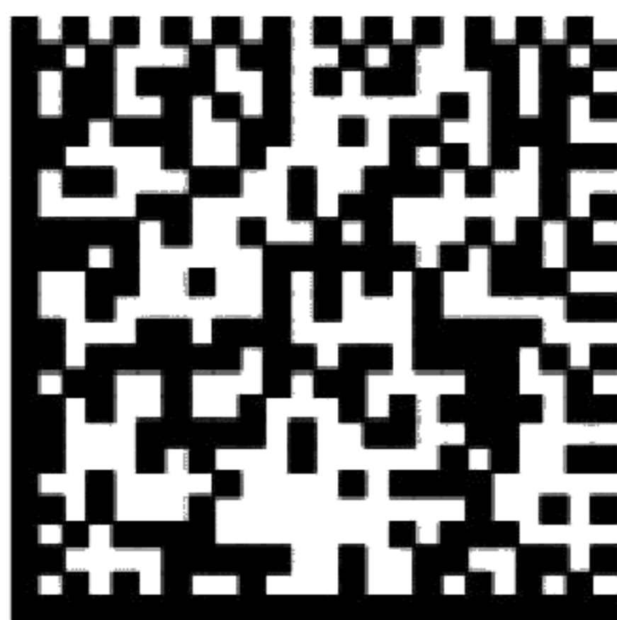
Рисунок А.5 — Символ DataMatrix, кодирующий содержимое сообщения
