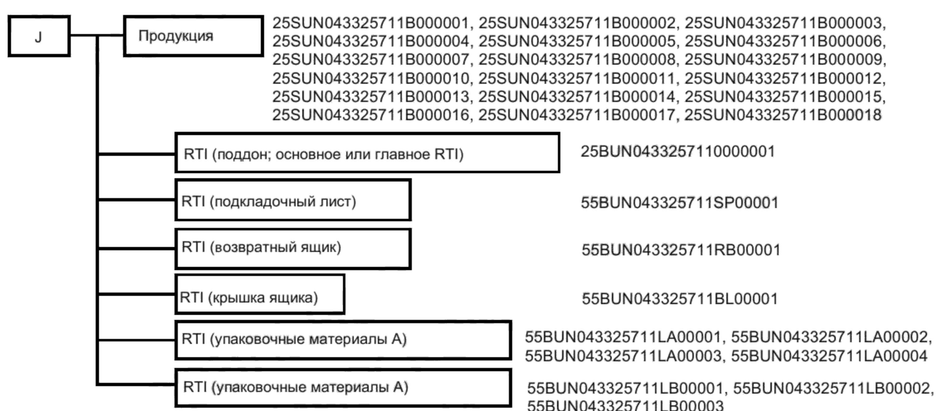
Рисунок Е.16 — Данные возвратных средств, управляемых независимо. Второй пример, вариант 2
